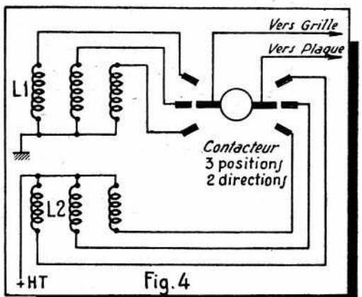
Les trois bobinages peuvent aisément être fixés de façon définitive sur un contacteur selon le schéma de la figure 4, de façon à constituer un bloc 3 gammes facile à monter.
