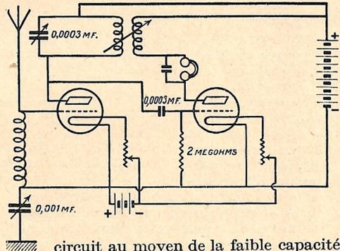
circuit au moyen de la faible capacité naturelle entre la grille et l'anode de la première lampe. Dans certains cas, quand la batterie à haute tension a une valeur élevée et que le filament est brillant, des oscillations naturelles de la première lampe peuvent prendre naissance par suite de cet
