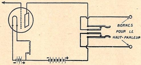
jack quittent le contact des deux ressorts intérieurs connectés au haut-parleur. Quand on a réussi à s'accorder sur un poste émetteur au moyen des écouteurs, il suffit, pour mettre le haut-parleur en action, de sortir la fiche des écouteurs, ce qui permet aux ressorts extérieurs de venir en contact avec les ressorts intérieurs, mettant ainsi le haut-parleur directement dans le circuit récepteur.
