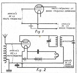
Un tel couplage apériodique est semblable à un couplage à résistance, les résistances étant remplacées par des bobines à haute fréquence. La dimension de ces bobines dépend de la longueur d'onde maximum nécessaire; en employant des bobines en panier d'environ 10 centimètres de diamètre extérieur
