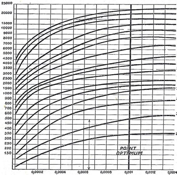
n'ajoute aucun condensateur variable en parallèle avec la bobine, on obtient facilement la longueur d'onde minimum sur laquelle la bobine choisie permettra l'accord du circuit d'antenne ; il suffira, pour cela, de tracer une ligne verticale à partir du point 0,0003 porté sur la ligne de base et de lire sur la colonne de gauche le chiffre correspondant au point d'intersection de cette verticale et à la courbe de la bobine.
